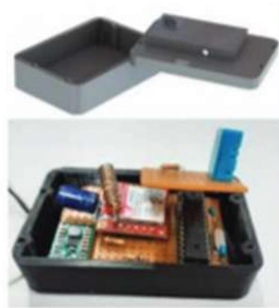
Figura 5: Dispositivo de rastreabilidade em tempo real.
